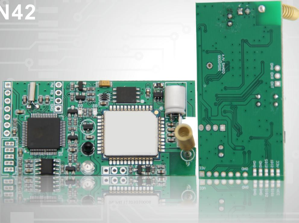
NB-IoT机械表模块具有两对脉冲信号检测端口，通过检测两个端口的脉冲信号及设定好的脉冲当量，可以计算当前流量值并进行存储，可记录结算日流量。模块在检测脉冲信号时进行防抖处理，可有效避免因外界干扰造成的误计量，提高了计量准确度。
