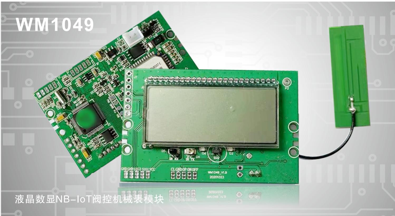
NB-IoT机械表模块具有两对脉冲信号检测端口，通过检测两个端口的脉冲信号及设定好的脉冲当量，可以计算当前流量值并进行存储，可记录结算日流量。模块在检测脉冲信号时进行防抖处理，可有效避免因外界干扰造成的误计量，提升了计量准确度。
